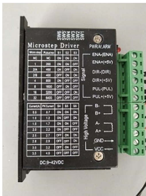
Slika 8: Toshiba TB6600HG IC upravljač stepper motora.
