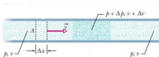
Slika 8. Element zraka širine  $\Delta x$  u cilindru koji se giba brzinom  $v$  prema području većeg tlaka. [1]
