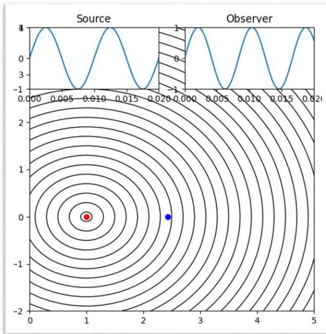
Slika 11. Izvor miruje, a promatrač se giba. Valne fronte izvora (crvena točka) se jednolikom šire u svim smjerovima, a promatrač (plavo) se giba prema izvoru te je zapažen porast u frekvenciji [10]
