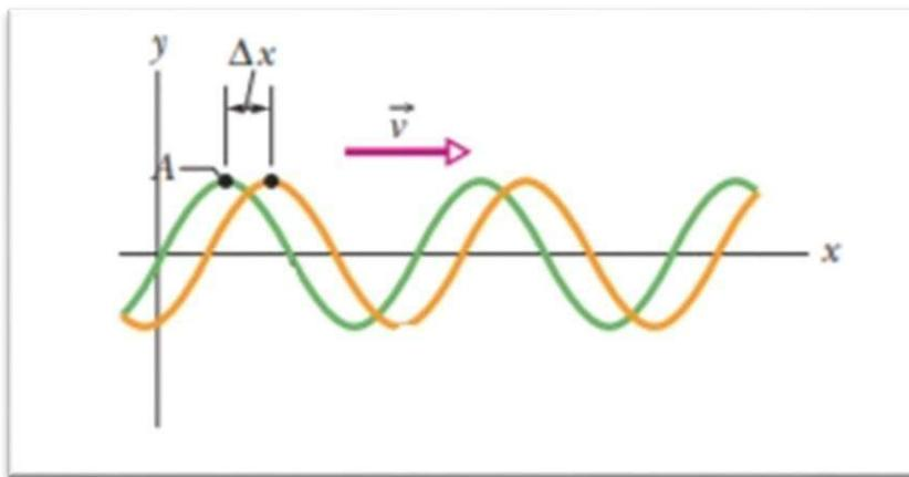
Slika 2. Val koji se giba brzinom  $v$  prema pozitivnom dijelu osi  $x$ . Na slici je označena točka  $A$  koja putuje zajedno s valom i prijeđe udaljenost  $\Delta x$ .[2]
