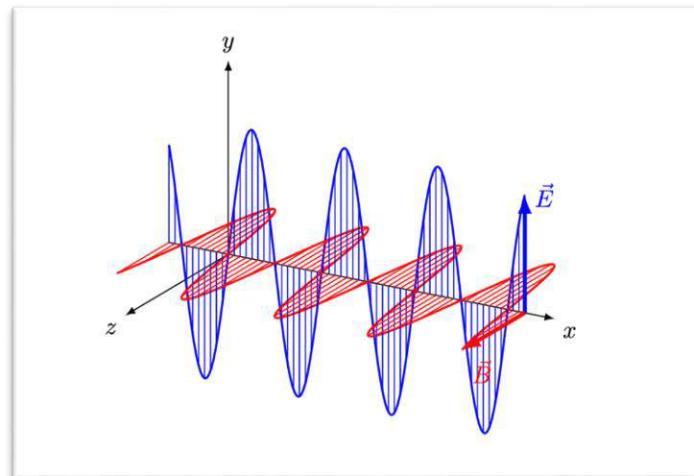
Slika 5. Elektromagnetski val u Kartezijevom koordinatnom sustavu.[6]
