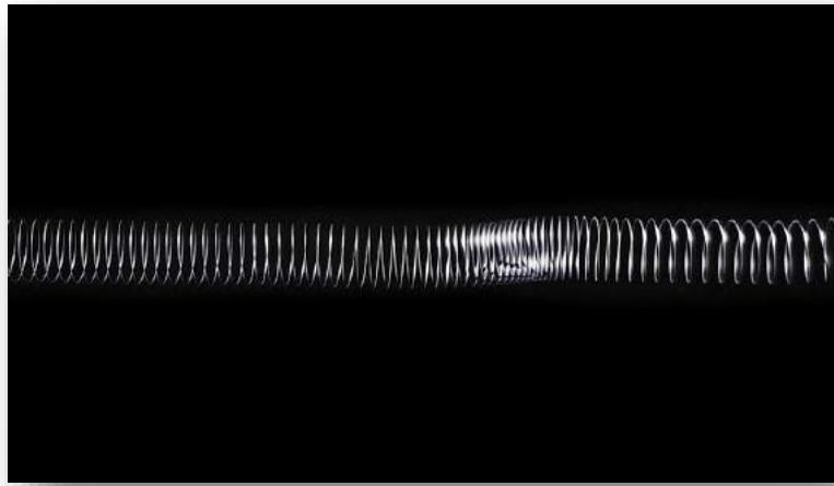
Slika 4. Longitudinalni val na elastičnoj opruzi [5]
