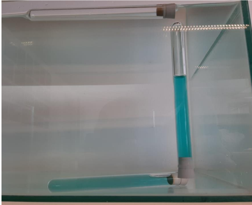
Slika 22. Pokus 8. Na fotografiji su prikazane 3 epruvete, jedna pluta, druga lebdi, a treća tone. Fotografija je uzeta s pogledom od dole tako da se vidi da epruveta koja lebdi ne dira dno.
