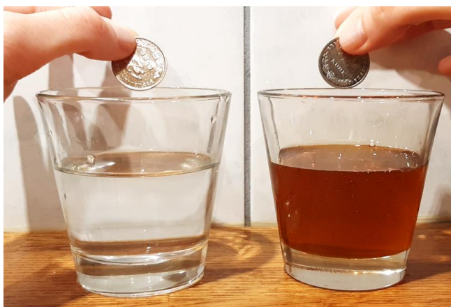
Slika 9. Pokus 2. U lijevoj čaši nalazi se voda, a u desnoj med. Na fotografiji je prikazan trenutak prije ispuštanja novčića u vodu i med.
