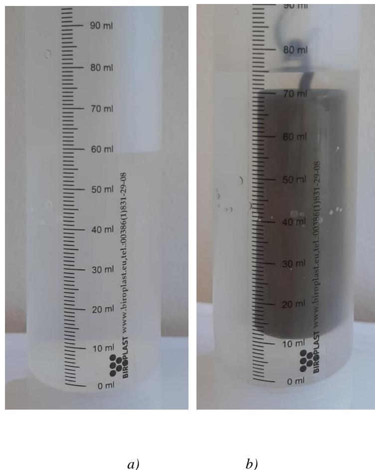
**Slika 21.** Pokus 7. Na fotografijama a) i b) prikazano je mjerjenje volumena istisnute tekućine kad se uteg stavi u vodu. Volumen se dobije oduzimajući volumen očitan na menzuri na slici b) i na slici a).
