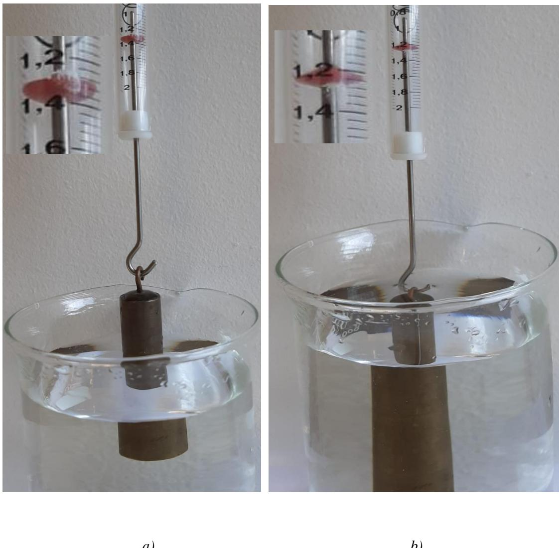
**Slika 16.** Pokus 6. Na fotografiji a) prikazan je iznos sile koja djeluje na uteg koji je samo dijelom uronjen u tekućinu, a na desnoj slici prikazan je iznos sile koja djeluje na uteg koji je potpuno uronjen u vodu. Vidi se da dinamometar na desnoj slici prikazuje manju vrijednost.
