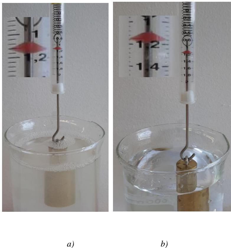
**Slika 12.** Pokus 3. Na fotografiji a) uteg je u slanoj vodi, a na fotografiji b) u slatkoj. Iznos sile na fotografiji a) je za  $0,04\text{ N}$  manji nego na fotografiji b) što znači da je sila uzgona veća u slanoj vodi.
