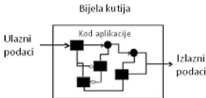
Slika 5. Testiranje po principu bijele kutije
