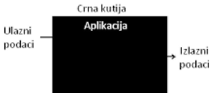
Slika 4. Testiranje po principu crne kutije
