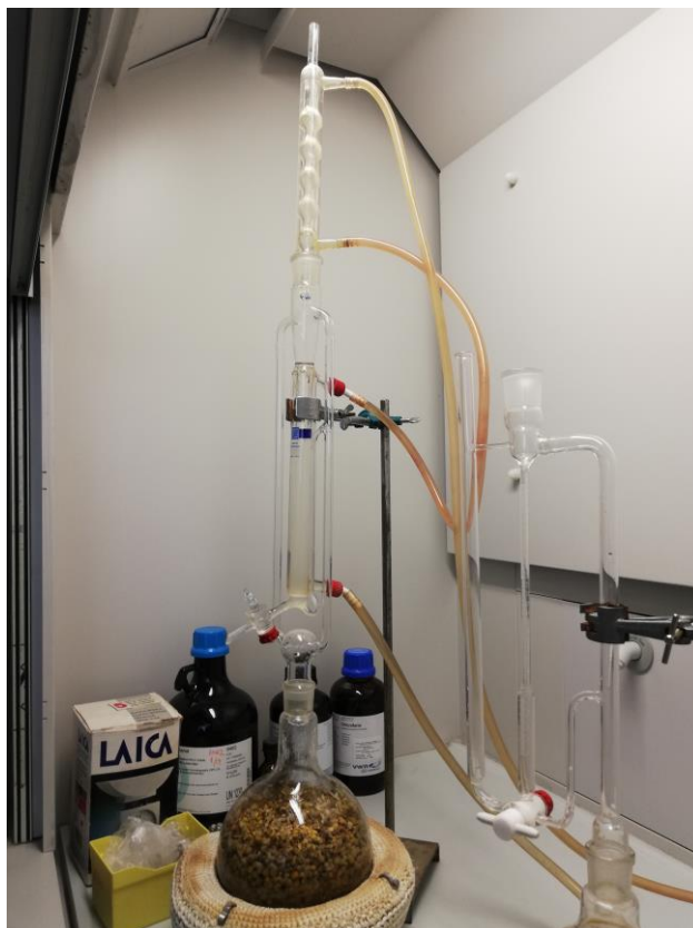
Slika 7. Aparatura za hidrodestilaciju eteričnog ulja kamilice
