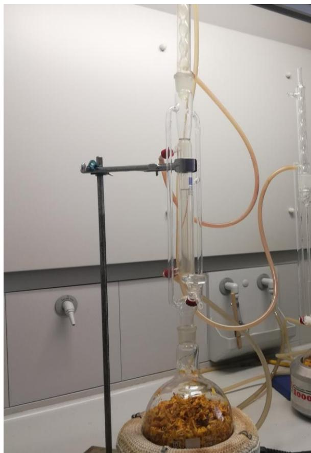
**Slika 8.** Aparatura za hidrodestilaciju eteričnog ulja brnistre
