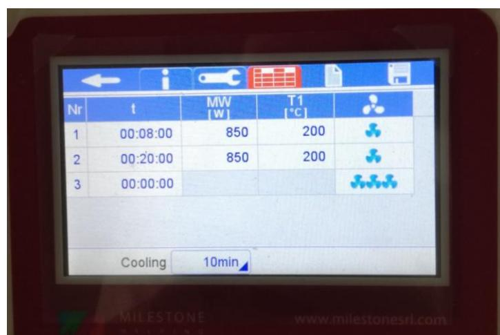
**Slika 6.** Mikrovalni program za sintezu čestica hematita
