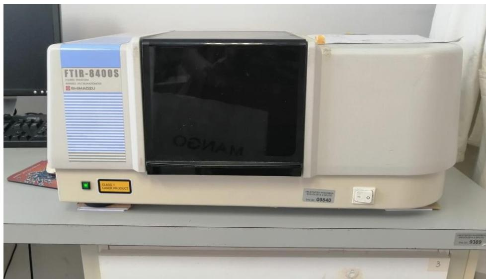
**Slika 9.** FTIR uređaj korišten za analizu uzorka
