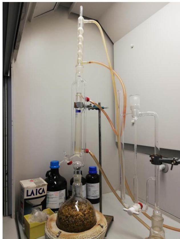
**Slika 7. Aparatura za hidrodestilaciju eteričnog ulja kamilice**
