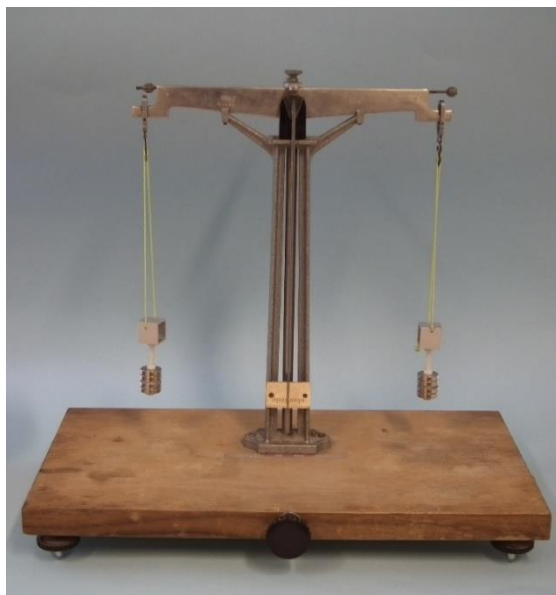
Slika 20. Magneti ovješeni o krakove vage.
