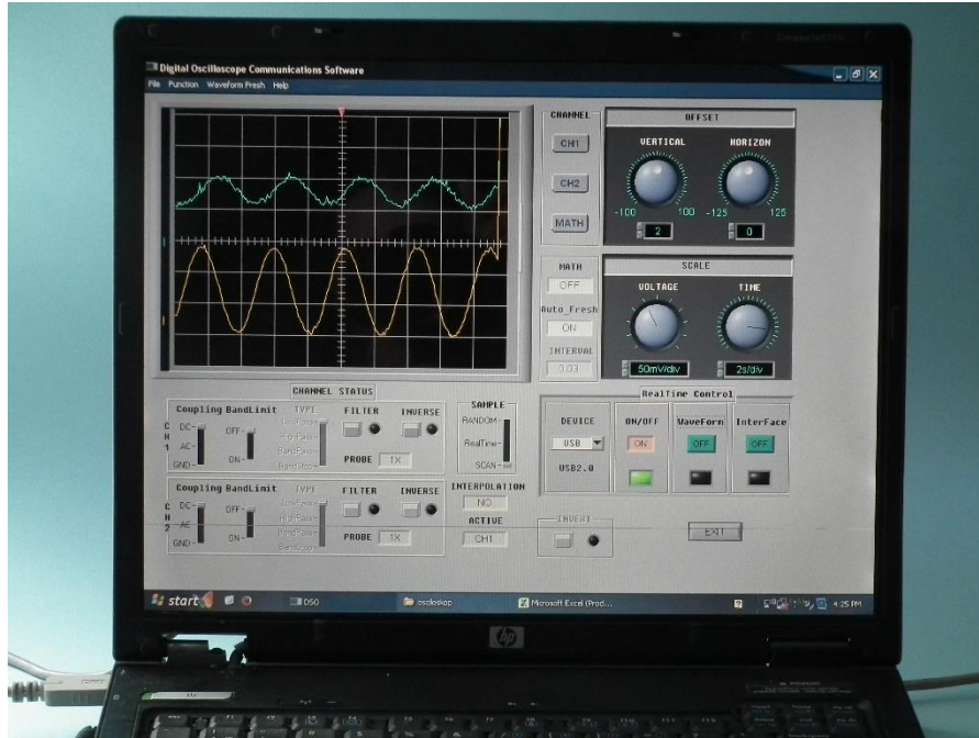
Slika 26. Zaslona računala sa sučeljem programa koji komunicira s osciloskopom.
