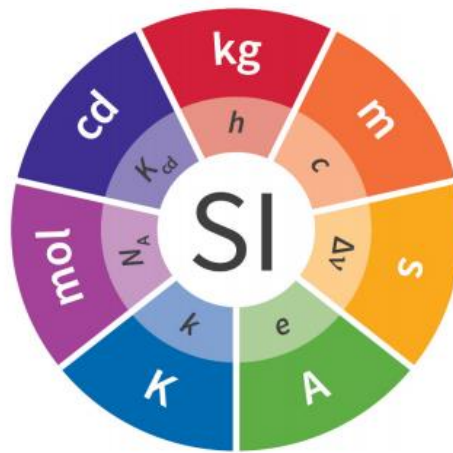
Slika 2. Službeni logo SI sustava ustupljen od strane BIPM-a sa 7 osnovnih mjernih jedinica i konstanti preko kojih su definirane [14].
