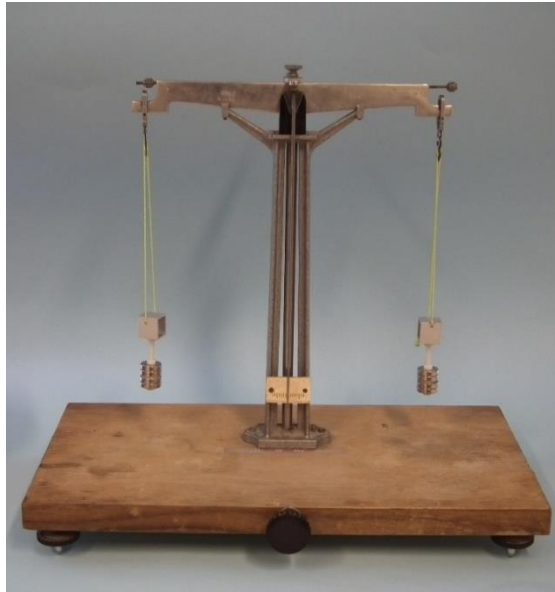
Slika 20. Magneti ovješeni o krakove vage.
