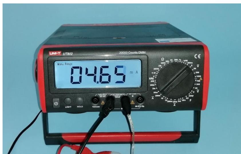
*Slika 30. Ampermetar*
