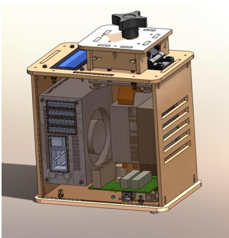
**Slika 2.** Uređaj OpenPCR za umnažanje uzorka DNA lančanom reakcijom polimerazom (preuzeto s <https://s3-us-west-2.amazonaws.com/oww-files-public/8/8c/OpenPCR.jpg>).
