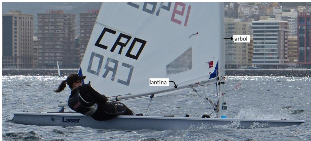
Slika 27. Lantina i jarbol na olimpijskoj klasi Laser Radial (fotografirao Goran Martinović, uzeto s dozvolom).
