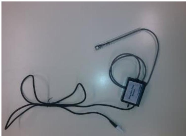
**Slika 2.4.** Senzor za mjerjenje magnetske indukcije
