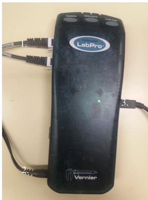
**Slika 2.1 :** Uređaj za prikupljanje mjernih podataka Vernier *LabPro*
