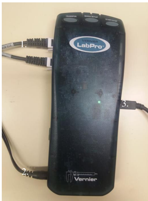
Slika 2.1 : Uređaj za prikupljanje mjernih podataka Vernier LabPro
