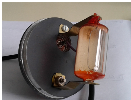
Slika 1.2: Fotoelektrična vakuumska cijev.
