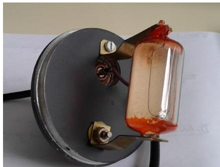
Slika 1.2: Fotoelektrična vakuumска cijev.
