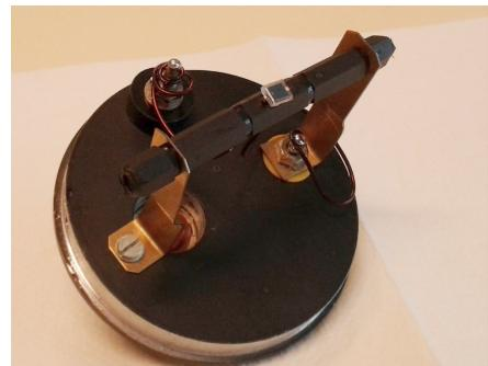
Slika 1.3: BPW34 fotodioda.
