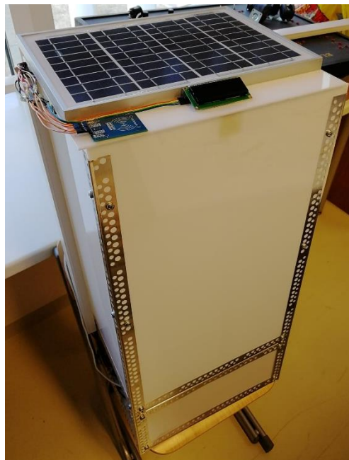
Slika 18. Izgled gotovog prototipa sa RFID sustavom za identifikaciju korisnika
