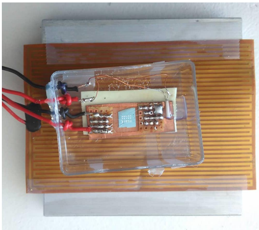
Slika 7.5. Na ploči aluminijske, visokog toplinskog kapaciteta (srebrna boja) postavljen je grijač (narančasta boja) na kojemu je uzorak zajedno s termometrom. Sve je smješteno u kutiju od stiropora.
