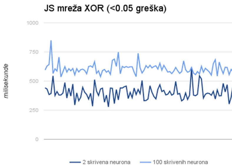
Slika 2.6 Vrijednosti vremena potrebnog za učenje JS mreže da prepozna XOR s manje od 0.05 vrijednosti greške prikazane u milisekundama. Četiri anomalije su isključene iz rezultata jer je mreži bilo potrebno više od minute za učenje, a zaustavilo se na 0.125 vrijednosti greške.
