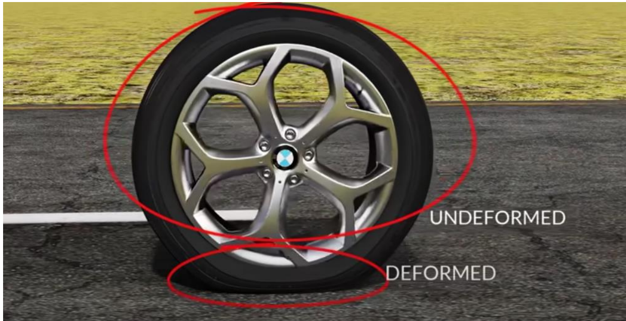
Slika 6. Deformirani i nedeformirani dio gume pri kotrljanju. Slika je preuzeta iz [4].
