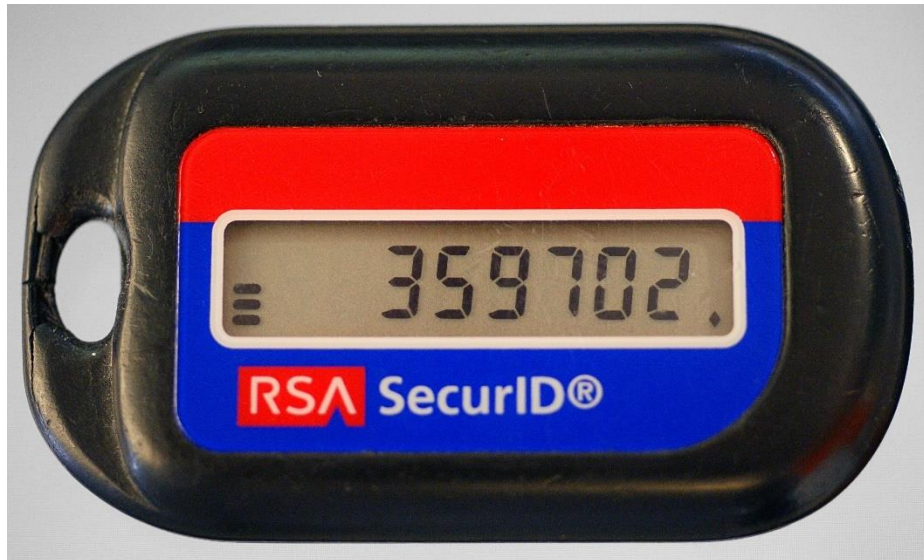
Slika 3 Prikaz fizičkog tokena za generiranje jednokratne lozinke [9]
