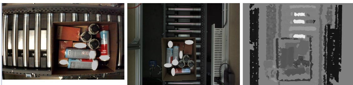
Slika 4.1: Primjer tripleta RGB slike obične kamere, RGB slike i odgovarajuće dubinske mape ToF senzora
