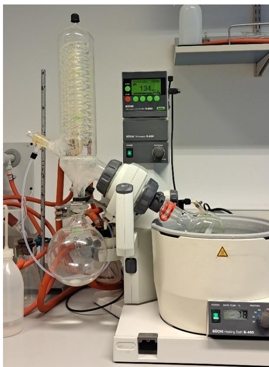
Slika 10. Uparavanje uzoraka na rotavaporu (Vlastita fotografija, veljača 2024.)
