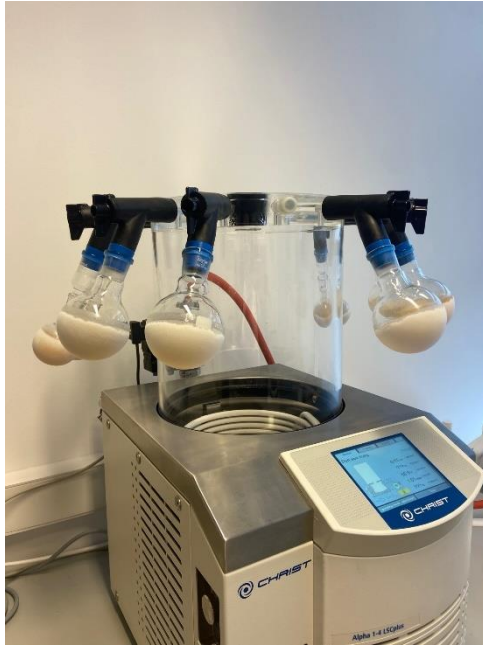
Slika 11. Uzorci na liofilizatoru (Vlastita fotografija, veljača 2024.)
