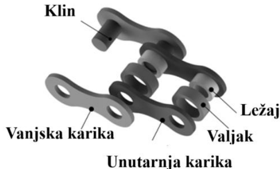
Slika 2.1 Shematski prikaz valjkastog lanca [12]
