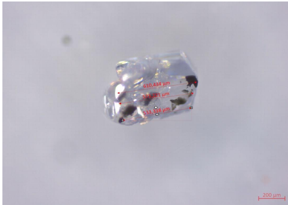
Slika 1.2 (a): Testni kristal anataze sa dimenzijama. Fotografirano u laboratoriju PMFST-a optičkim mikroskopom
