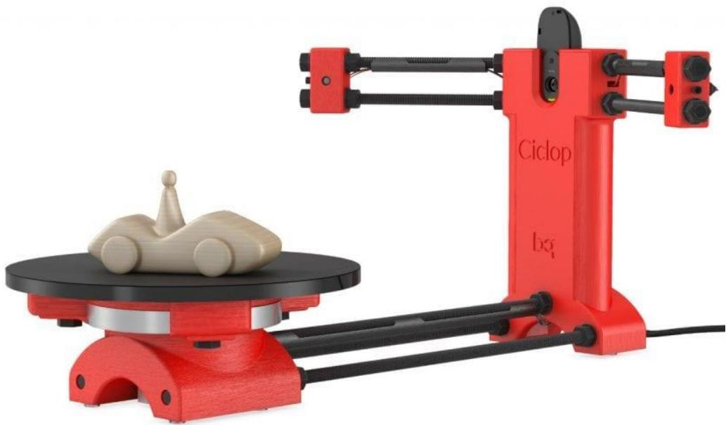
Slika 2.5 - Triangulacijski skener [19]
