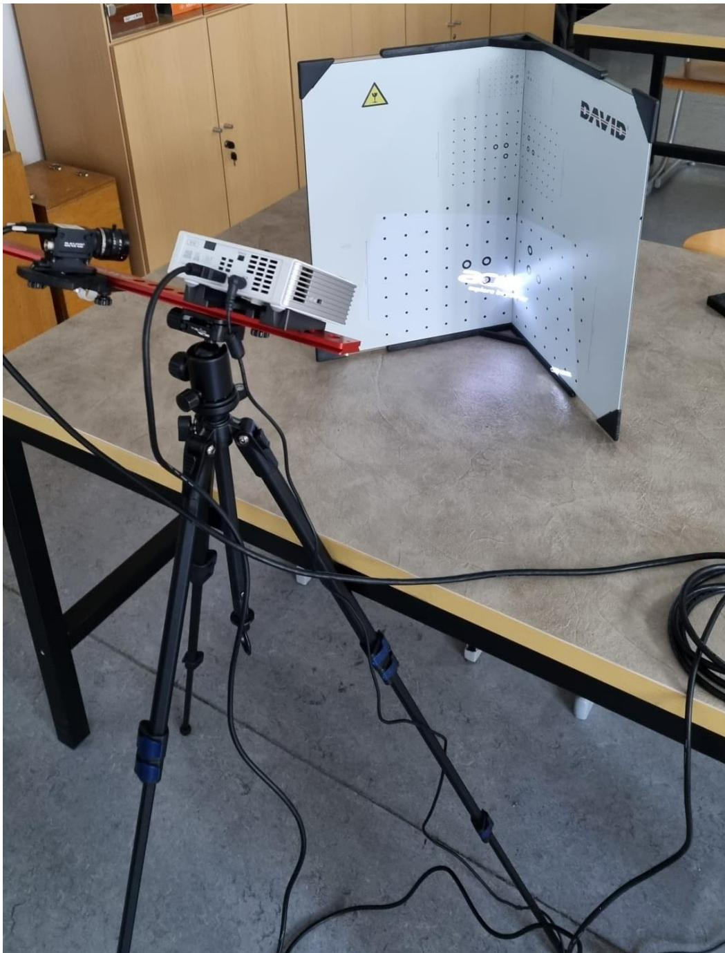
Slika 4.3 – Ploče za kalibraciju
