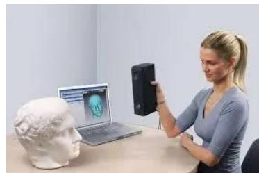
Slika 2.7 - Modularni svjetlosni skener [21]
