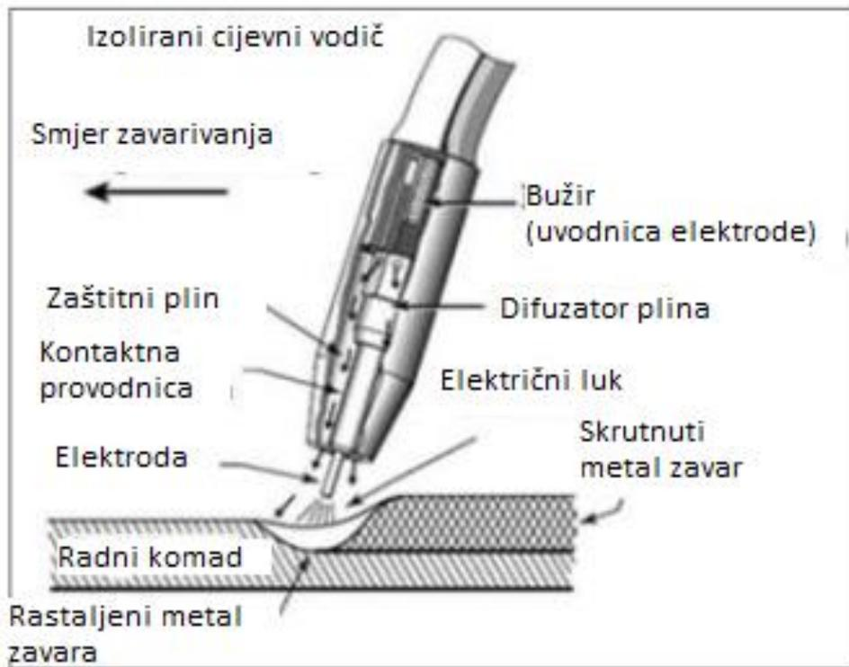
Slika 12: Shema poprečnog presjeka pištolja za zavarivanje[5]
