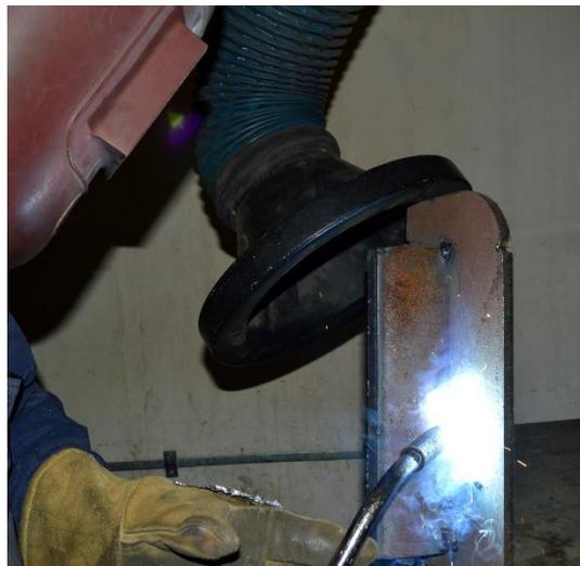
*Slika 3: Zavarivanje MAG postupkom[8]*
