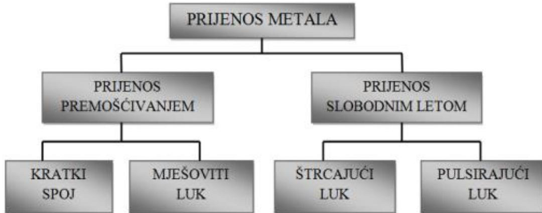
Slika 13: Shema mehanizma za prijenos metala kod MAG zavarivanja[4]
