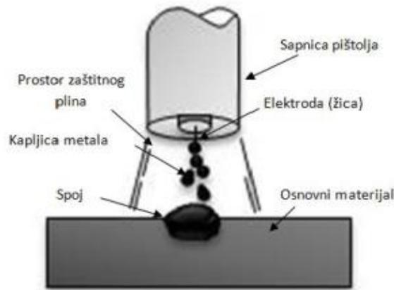
Slika 15: Shema prijenosa metala mješovitim spojem[4]
