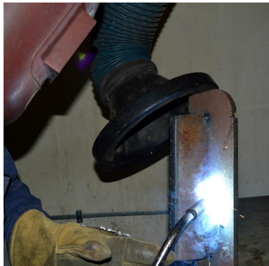
Slika 3: Zavarivanje MAG postupkom[8]
