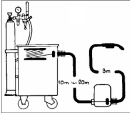
Slika 10: Tandemski sustav za dovođenje žice[12]
