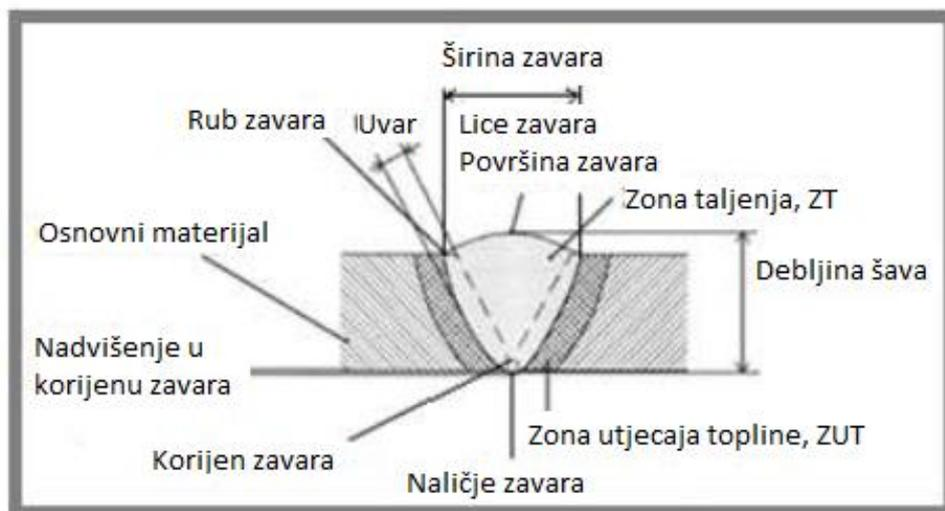
Slika 2: Dijelovi zavora[2]
