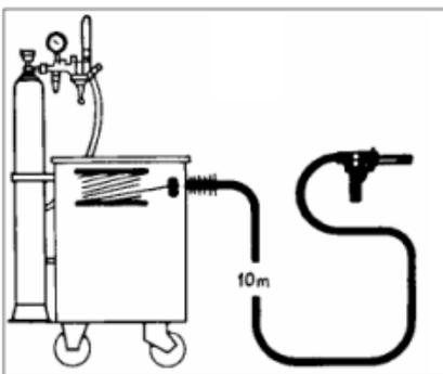
Slika 11: „Push – pull“ sustav za dovođenje žice[12]
