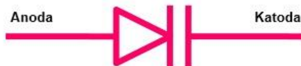
Slika 4.12 Simbol varikap diode [34]
