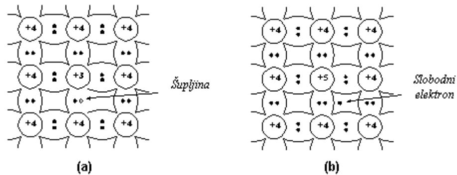
Slika 3.2 a) P-tip poluvodiča, b) N-tip poluvodiča [13]
