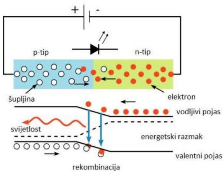
Slika 4.5 Generiranje svjetlosti kod LED dioda [25]
