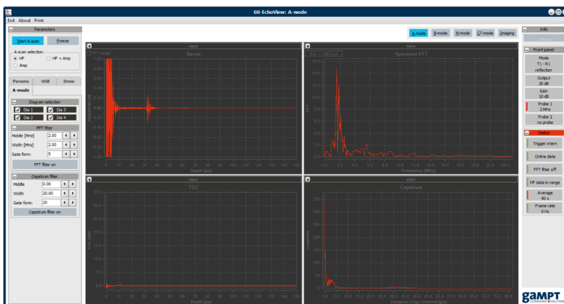
Slika 4. Slika prikazuje pokrenut program pri mjerenju. Amplituda reflektiranog ultrazvučnog vala se očitava iz gornjeg lijevog grafa.
