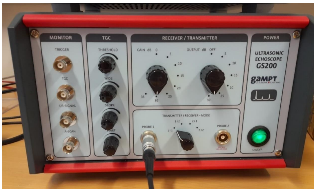
Slika 3. Upravljačka ploča ultrazvučnog ehoskopa GS2000
