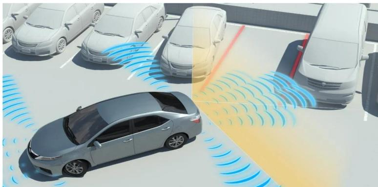
Slika 9 Ultrazvučni senzori
