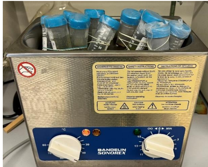
Slika 7. Ultrazvučna kupelj na 40°C
