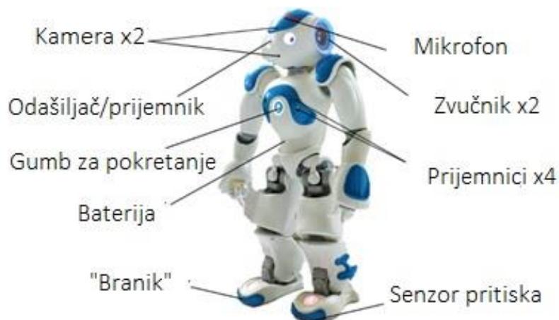
Slika 3.10 Nao robot- dijelovi
