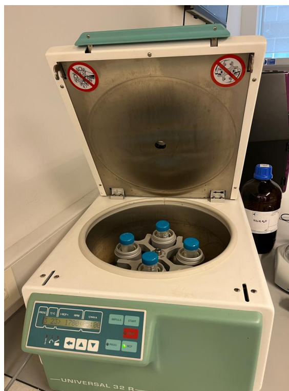
Slika 9. Centrifugiranje nakon ekstrakcije (izvor: vlastita izrada)
