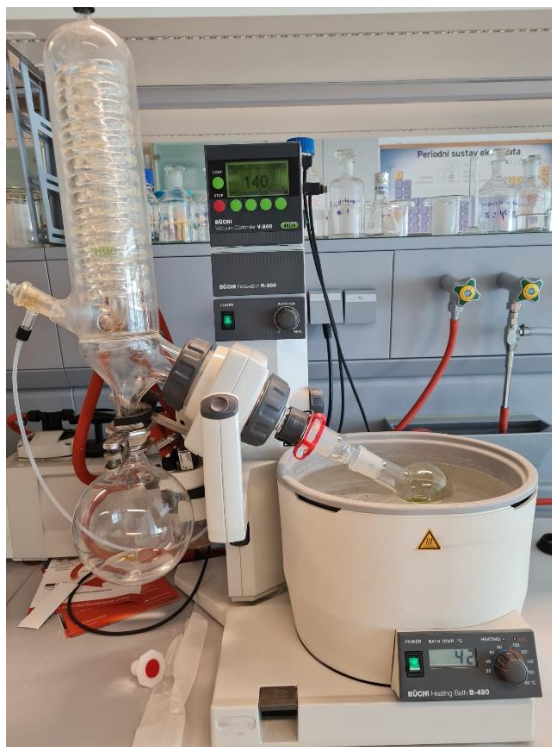
Slika 6. Rotavapor (izvor: vlastita izrada)
