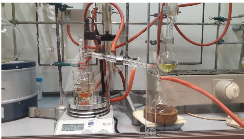
Slika 15: Destilacija pri sniženom tlaku
