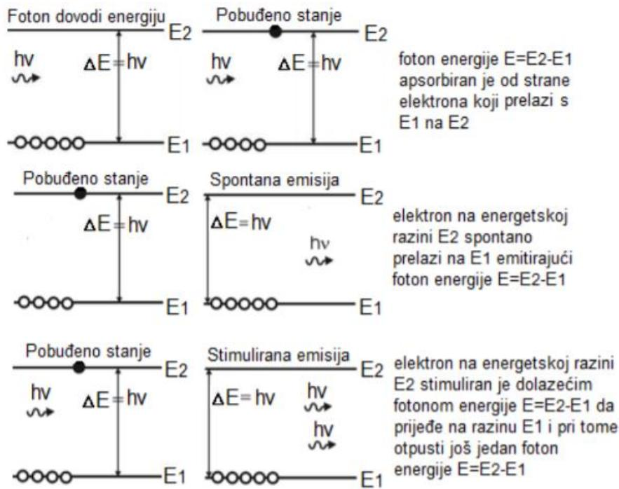
Slika 3.2 Ukratko objašnjen proces nastanka laserske svjetlosti (slika preuzeta s [http://repozitorij.fsb.hr/5112/1/Antoli%C4%87\\_2016\\_Zavr%C5%A1ni\\_Preddiplomski.pdf](http://repozitorij.fsb.hr/5112/1/Antoli%C4%87_2016_Zavr%C5%A1ni_Preddiplomski.pdf) [10])
