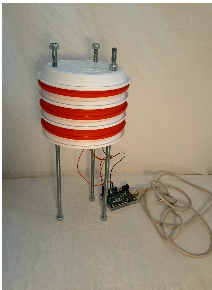
Slika 8: Završeno kućište meteorološke postaje (izvor: autor)
