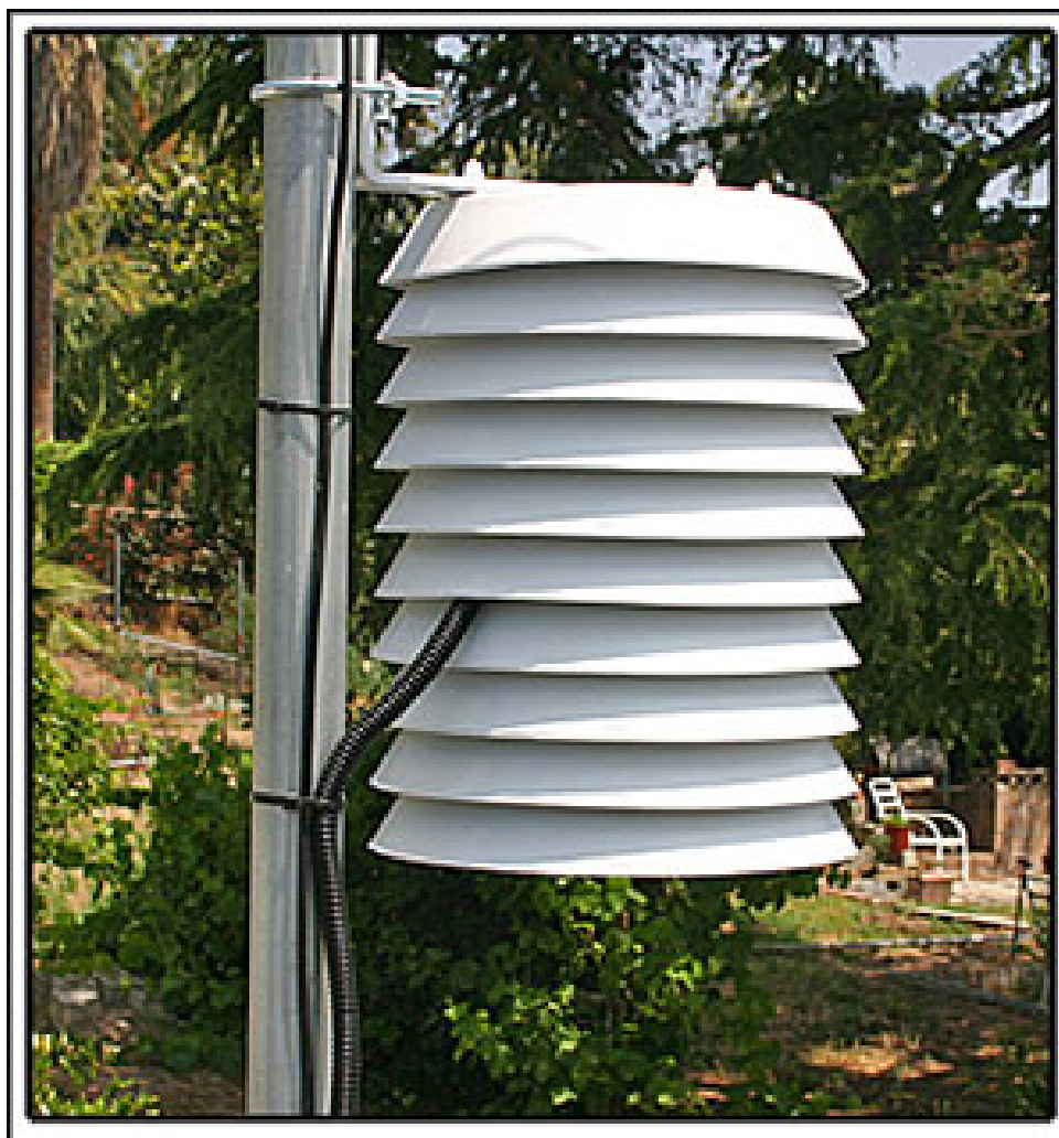
Slika 2: Varijanta Stevnssovog zaklona izgrađena od plastičnih tanjurića obojanih u bijelu boju . (preuzeto s: https://pljusak.com/img/site/zaklon_plastik.jpg )
