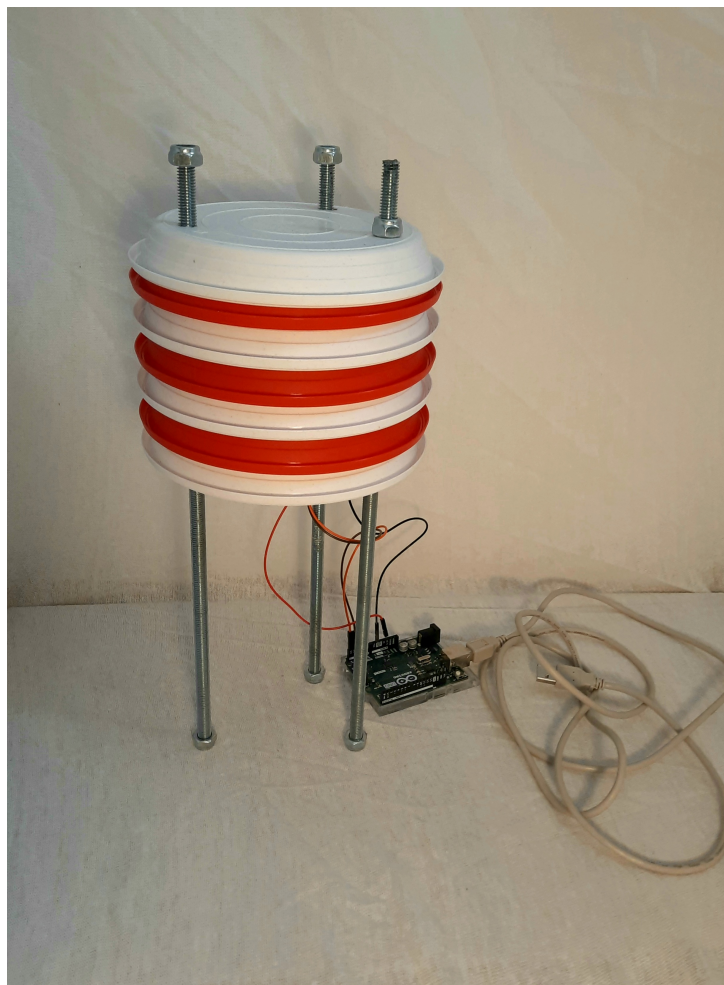
Slika 8: Završeno kućište meteorološke postaje (izvor: autor)
