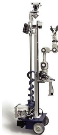
Slika 4 - Robot E-LE razvijen u Georgia Tech za studije o pomaganju starima i onemogućenima.
