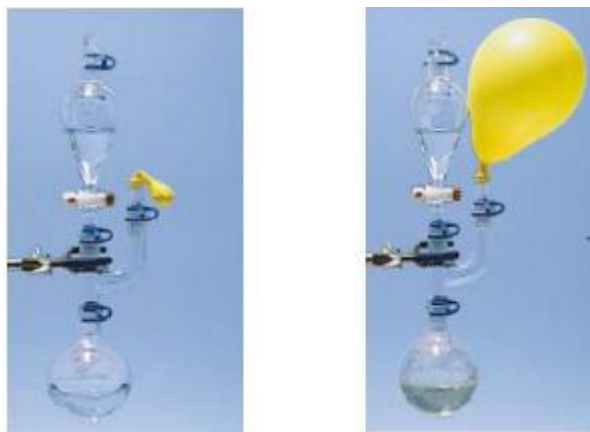
Slika 9. Kataliza raspada \text{H}_2\text{O}_2 uz \text{I}^- kao katalizator 4
