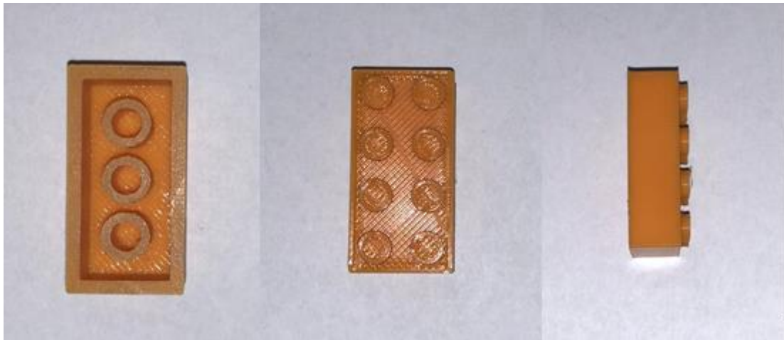
Slika 3.12 LEGO kockica dobivena uz pomoć Ender-3 Pro pisača
