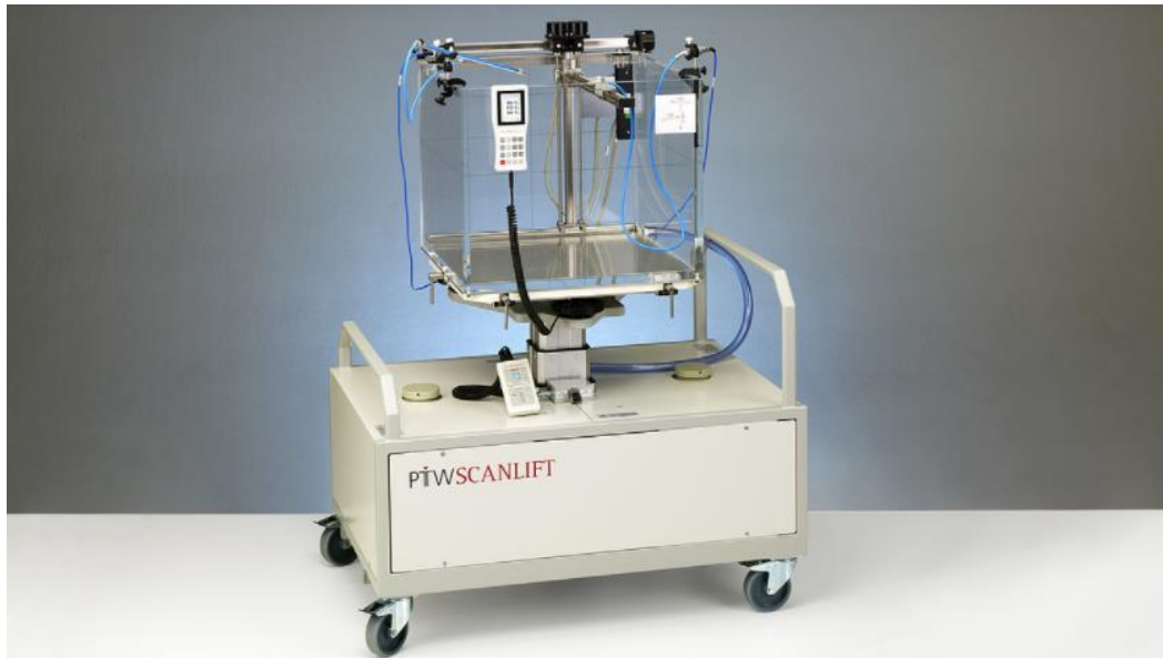
Slika 4. „MP3-M“ motorni 3D, vodeni fantomski sustav. (Preuzeto s http://ptwdosimetry.com [8])
