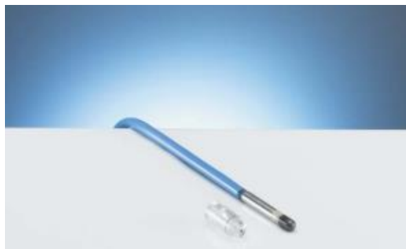
Slika 8. Ionizacijska komora PTW Semiflex 31010 . (Preuzeto s http://ptwdosimetry.com [8])
