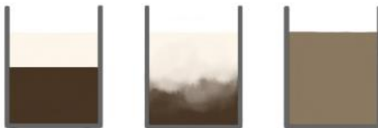
Slika 5. Prikaz 3 posude s kavom i mlijekom. Prva posuda prikazuje stanje s niskom entropijom gdje su sloj kave i sloj mlijeka jasno razdvojeni. Druga posuda prikazuje stanje u kojem se slojevi miješaju, koje je znatno složenije od prvog i ima višu entropiju. Treća posuda prikazuje homogenu smjesu kao novo ravnotežno stanje koje je ponovno jednostavno ali je entropija maksimalna. (prema ideji iz [1])
