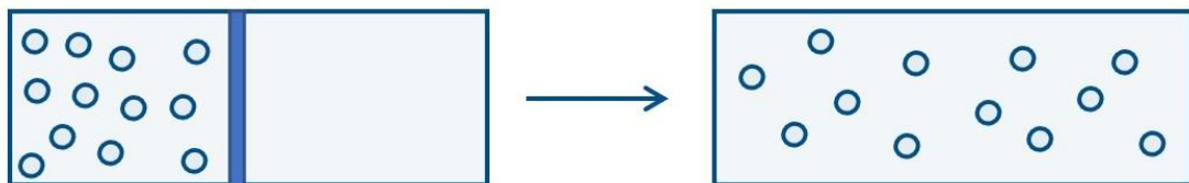
Slika 2. Shematski prikaz molekula idealnog plina unutar spremnika. U početnom trenutku (lijevo) spremnik je odijeljen pregradom na dva dijela te se sav plin nalazi na jednoj strani. Nakon što uklonimo pregradu (desno), plin se raširio cijelim spremnikom. (prema ideji iz [2])
