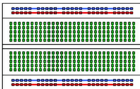
Slika 4: Shematski prikaz elektroničke pločice (slika preuzeta iz prezentacije [3])
