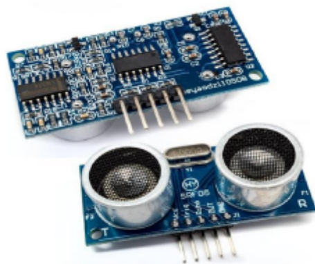
Slika 14: HY-SRF05 ultrazvučni senzor.(slika preuzeta iz [5])
