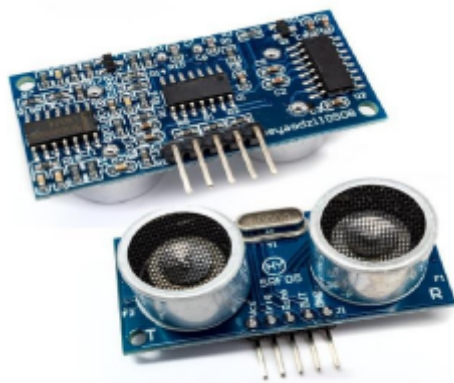
Slika 14: HY-SRF05 ultrazvučni senzor.(slika preuzeta iz [5])
