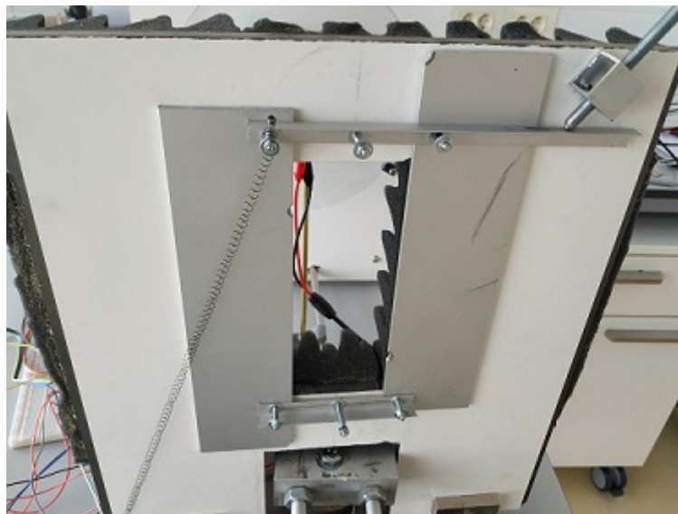
Slika 5: Mehaniizam za reguliranje širine pukotine.
