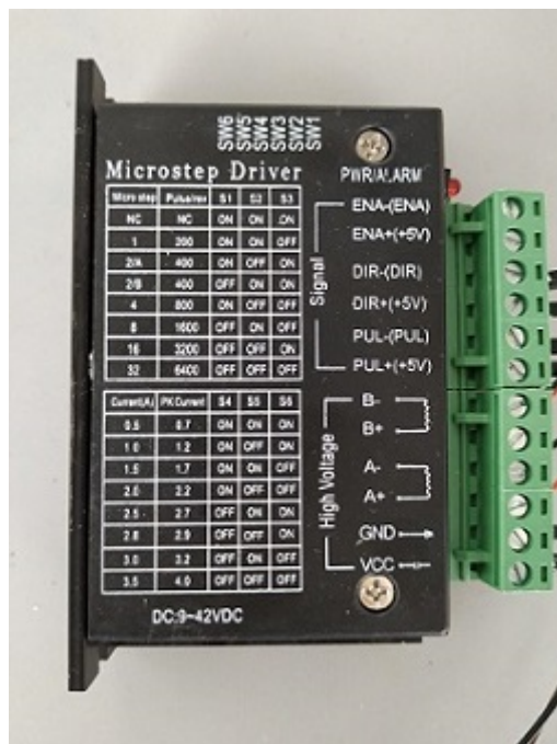
Slika 8: Toshiba TB6600HG IC upravljač stepper motora.
