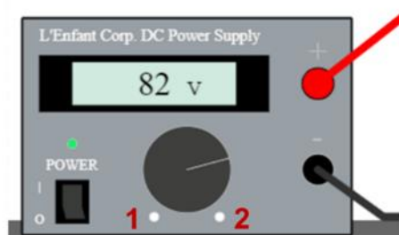
Slika 3.4 Izvor napona. Vrijednosti napona na grijacu se mijenjaju pritiskanjem tipki 1 i 2.
