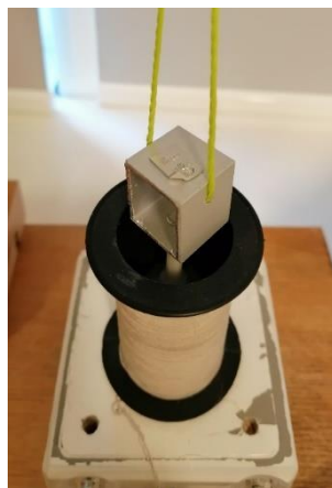
Slika 44. Uteg od 200 mg postavljen na nosač tereta.
