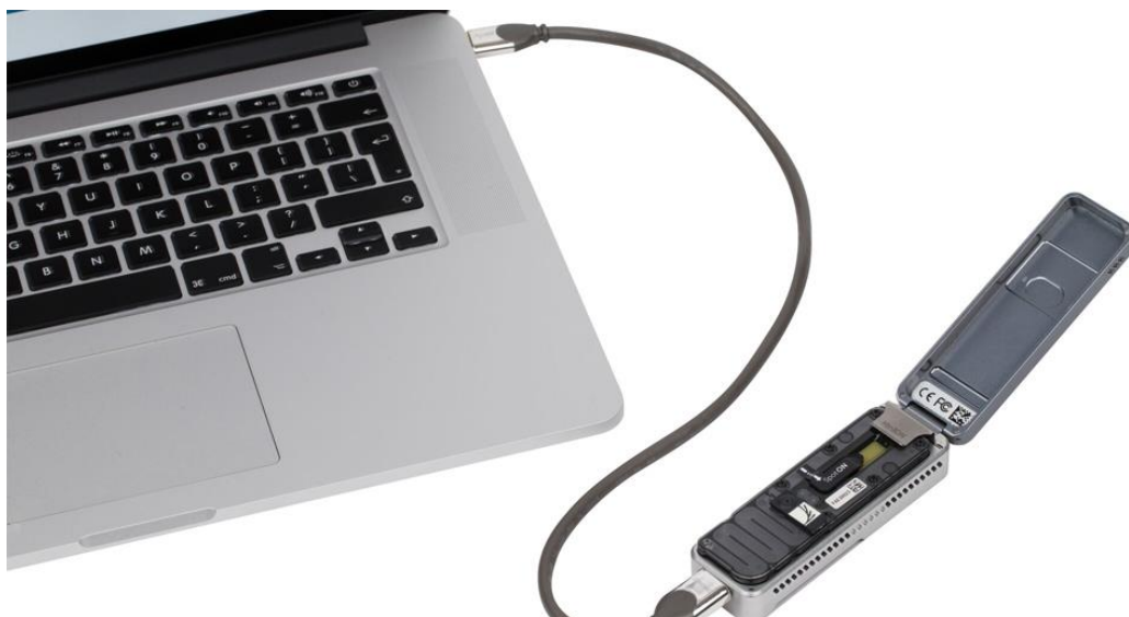
Slika 3. Prijenosni sekvenator MinION (preuzeto sa https://scx1.bcdn.net/csz/news/800/2015/minidnaseque.jpg )
