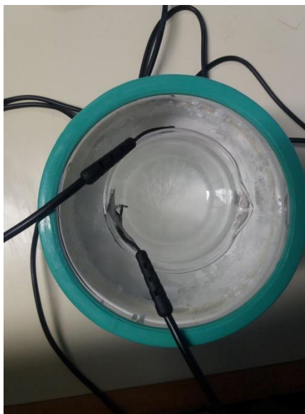
Slika 3.8.2. Laboratorijska čaša s vodom uronjena u termos bocu s mješavinom leda, soli i vode i temperaturnim senzorima
