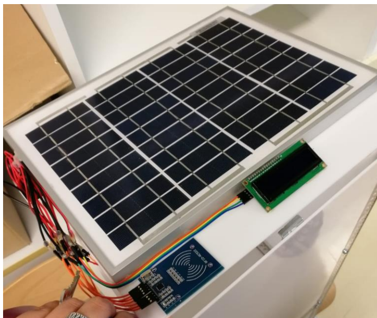
Slika 13. Raspored komponenti na poklopcu kante
