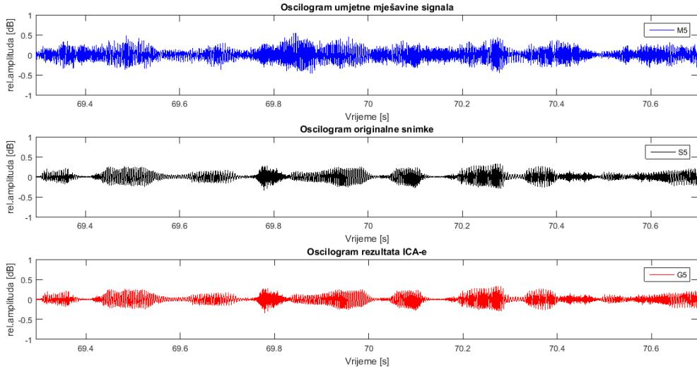
Graf 26: Plavom bojom je označen oscilogram mješavine signala na petom mikrofonu (M5), crnom bojom je označen oscilogram petog izvornog signala (S5), a crvenom oscilogram rezultata ICA-e koji odgovara petom izvoru (G5).
