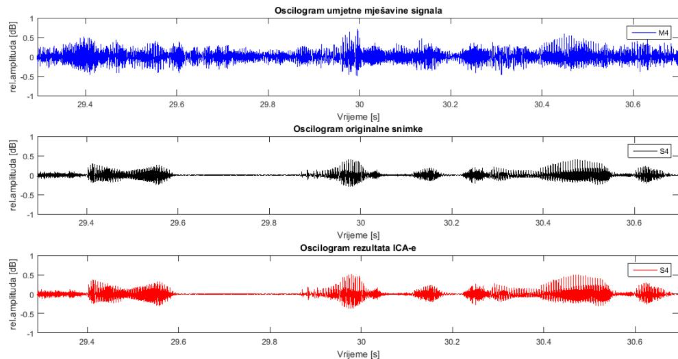
Graf 25: Plavom bojom je označen oscilogram mješavine signala na četvrtom mikrofonu (M4), crnom bojom je označen oscilogram četvrtog izvornog signala (S4), a crvenom oscilogram rezultata ICA-e koji odgovara četvrtom izvoru (G4).
