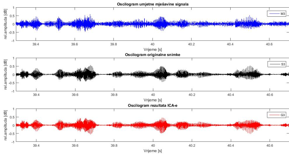
Graf 24: Plavom bojom je označen oscilogram mješavine signala na trećem mikrofonu (M3), crnom bojom je označen oscilogram trećeg izvornog signala (S3), a crvenom oscilogram rezultata ICA-e koji odgovara trećem izvoru (G3).
