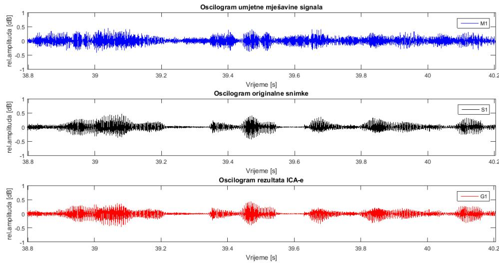
Graf 22: Plavom bojom je označen oscilogram mješavine signala na prvom mikrofonu (M1), crnom bojom je označen oscilogram prvog izvornog signala (S1), a crvenom oscilogram rezultata ICA-e koji odgovara prvom izvoru (G1).
