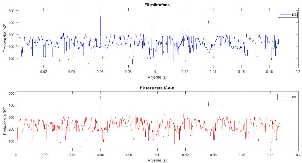
Graf 19: Plavom bojom je označena fundamentalna frekvencija mješavine signala na trećem mikrofonu (M3), a crvenom fundamentalna frekvencija rezultata ICA-e koji odgovara trećem govorniku (G3).
