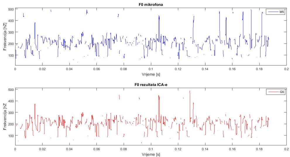
Graf 21: Plavom bojom je označena fundamentalna frekvencija mješavine signala na petom mikrofonu (M5), a crvenom fundamentalna frekvencija rezultata ICA-e koji odgovara petom govorniku (G5).
