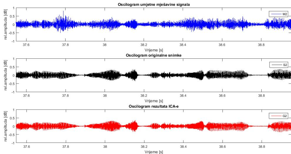
Graf 23: Plavom bojom je označen oscilogram mješavine signala na drugom mikrofonu (M2), crnom bojom je označen oscilogram drugog izvornog signala (S2), a crvenom oscilogram rezultata ICA-e koji odgovara drugom izvoru (G2).
