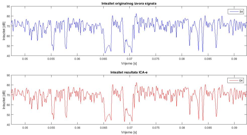
Graf 30: Plavom bojom je označen intenzitet četvrtoog izvornog signala (S4), a crvenom intenzitet rezultata ICA-e koji odgovara četvrtom izvoru (G4).
