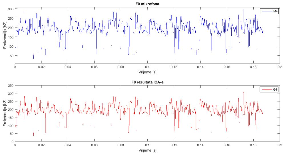
Graf 20: Plavom bojom je označena fundamentalna frekvencija mješavine signala na četvrtom mikrofonu (M4), a crvenom fundamentalna frekvencija rezultata ICA-e koji odgovara četvrtom govorniku (G4).
