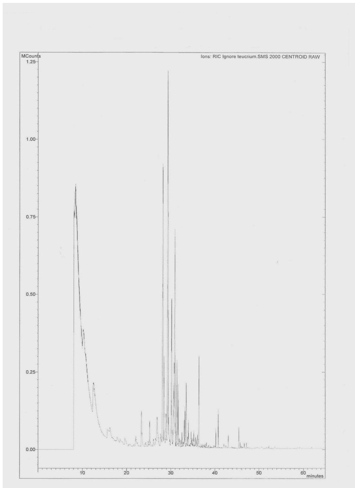
**Slika 24.** Kromatogram ukupne ionske struje za eterično ulje vrste *Teucruium arduini* L. na koloni CP Sil 8CB. Najveći pik je spoj  $\beta$ -kariofilen
