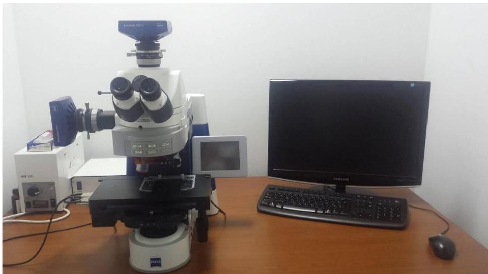
**Slika 10.** Fluorescencijski mikroskop s visoko rezolucijskom mikroskopskom kamerom (Carl Zeiss AxioCam MR Rev3).
