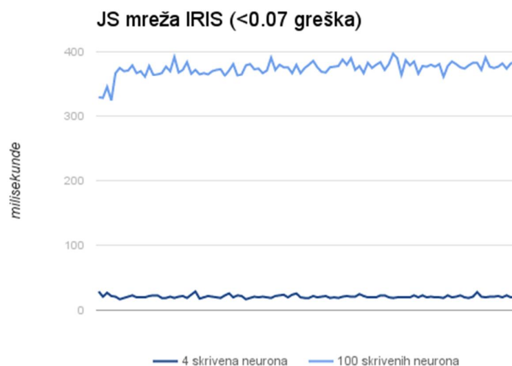
Slika 2.10 Vrijednosti vremena potrebnog za učenje JS mreže da prepozna iris cvjetove s manje od 0.07 vrijednosti greške prikazane u milisekundama.
