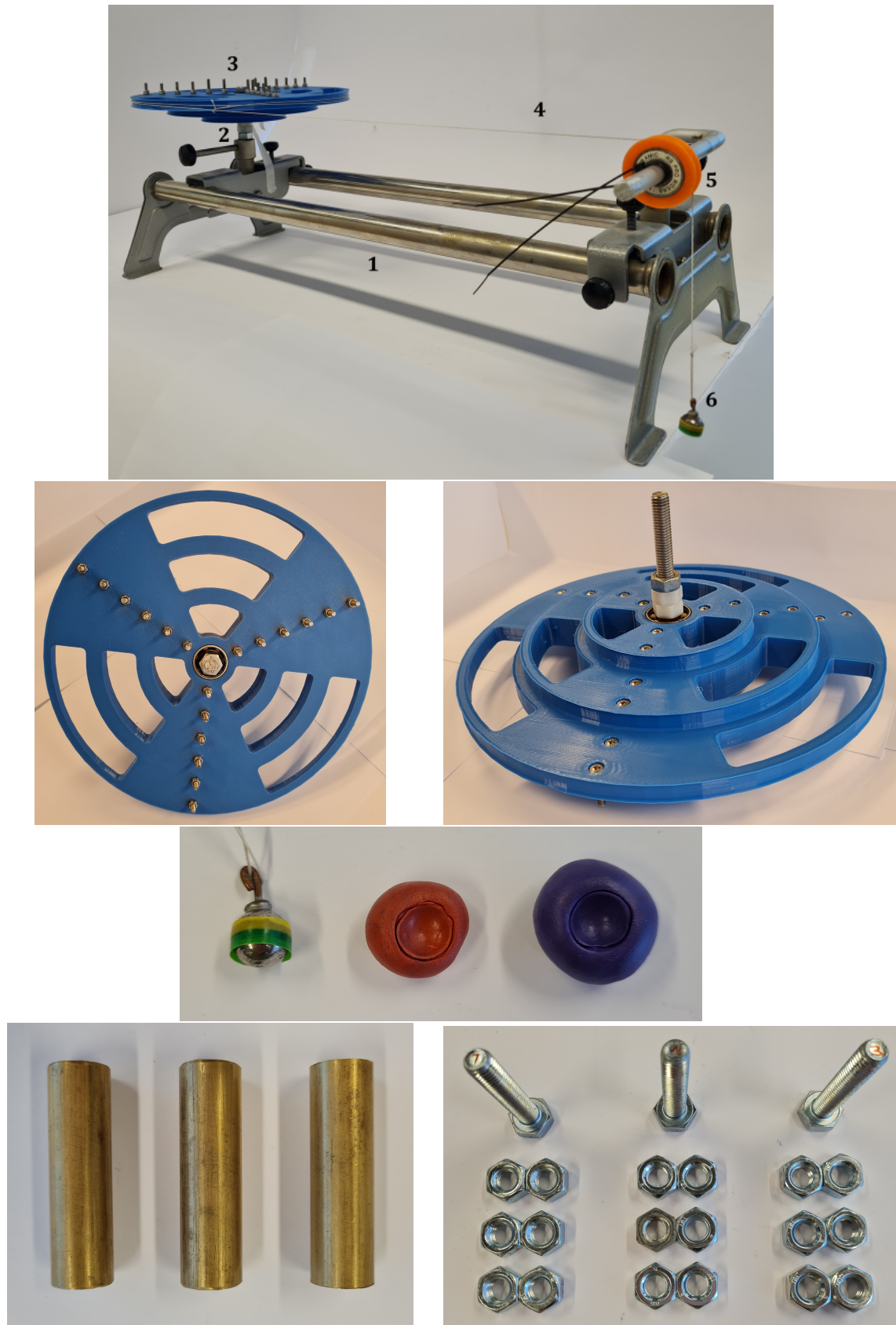
Slika 28: (a) Fotografija eksperimentalnog postava: metalna konstrukcija (1), osovina (2), rotirajući disk (3), nit (4), kolotura (5), tijelo (6). (b) Disk s gornje strane. (c) Disk s donje strane. (d) Tijela koja stavljamo na kraj niti. (e) Tijela koja postavljamo na vijke na disku.
