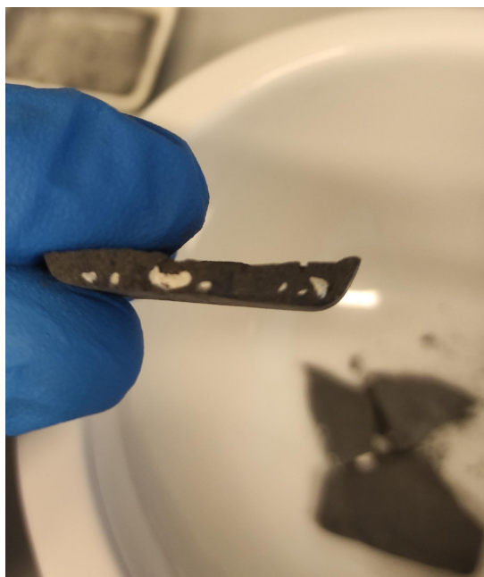
Slika 5.1: Sintetizirani bakrovi i kositrovi oksidi prije mljevenja.
